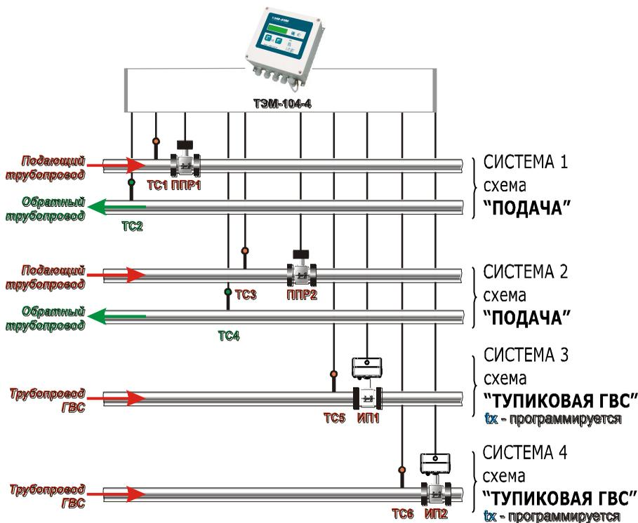
**Схема электрических подключений («ПОДАЧА» + «ПОДАЧА» + «ТУПИКОВАЯ ГВС» + «ТУПИКОВАЯ ГВС»)**
